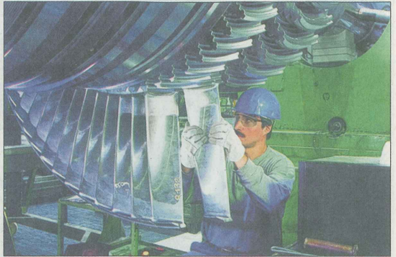
Aufwendige Produkte: Einzelne Schaufeln werden in Niederdruckdampfturbinen verbaut. Sie sollen möglichst lange zuverlässig arbeiten. Foto: Siemens
